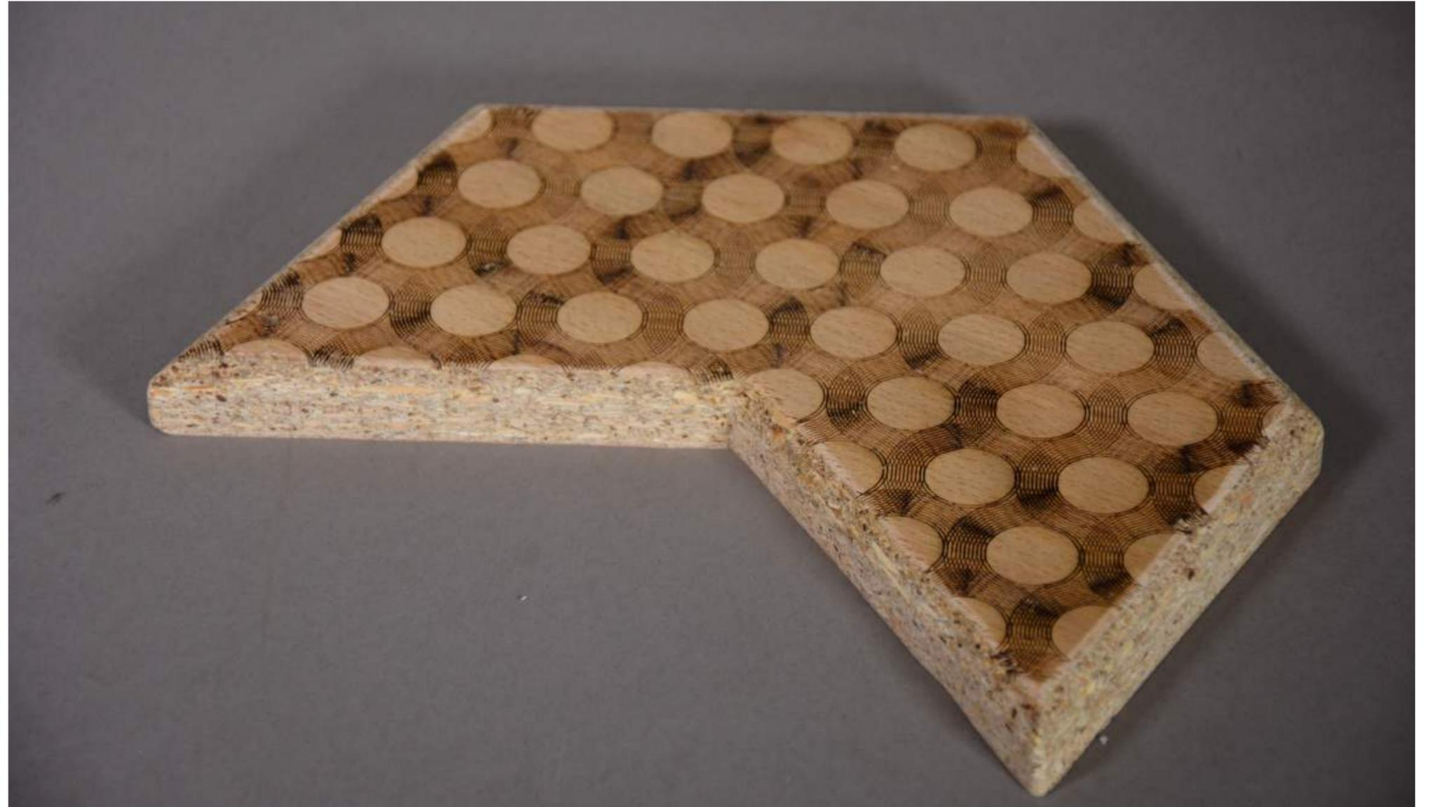
*Prototypes échelle 1:1, graver à la laser et finit a la scie. L'objectif serait de les produire entièrement à la Commande Numérique.*
