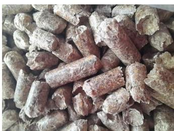
Les **granulés de bois** (ou pellets) désignent un combustible constitué de sciures compactées formant de petits cylindres. Ils sont généralement fabriqués à partir de sciures de résineux où la résine joue le rôle de **liant naturel**. Les granulés peuvent être vendus en sac ou en vrac.
