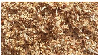
Les **connexes de la première transformation** sont les résidus obtenus lors du sciage du bois. Environ la moitié du volume de grumes entrant dans une scierie en ressort sous forme de connexes.
