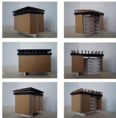
Ce service de location se concrétise par la création d'un abri pour héberger les kayaks et par l'aménagement des berges pour leur mise à l'eau. L'abri repose sur un bloc auto-portant de pierre qui soutient l'ensemble de la structure dotée d'une charpente en sapin, réalisée avec une technique d'assemblage par moisage et habillée d'une couverture en zinc.
