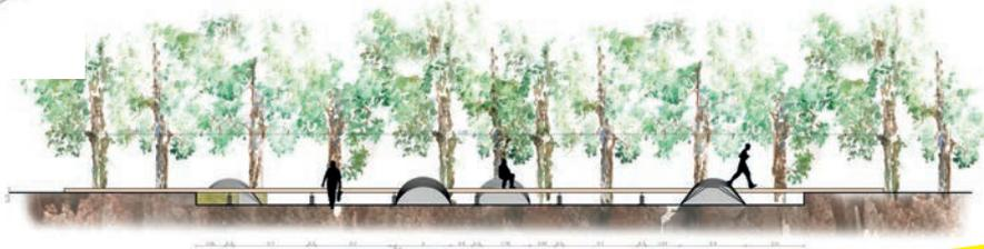
Ce cheminement permet de déambuler dans le site à tous les temps même en cas de crue. Il est constitué de trois passerelles qui, adaptées au dénivelé du site et surélevées de 50 cm, procurent à l'utilisateur une sensation de flottement accentuée par un revêtement de lames de sapin à claire-voie. Des blocs de pierre découpés en lames élarguées sur les arêtes, pour permettre à l'utilisateur de s'asseoir, supportent ces passerelles à l'aide de cales et de profilés métalliques.
