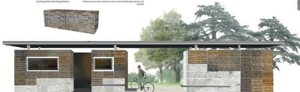
Cette nouvelle capitainerie abrite un espace d'accueil et des sanitaires. Le bâtiment se démarque par une utilisation innovante du gabion : les pierres qui le remplissent traditionnellement sont remplacées par des bardeaux et des tavaillons en sapin issus de lots de récupération. Les gabions ainsi comblés servent de murs porteurs protégés par une toiture à rebord. Le projet permet ainsi de recycler un produit local en fin de vie et de valoriser la diversité des teintes du bois vieilli.
