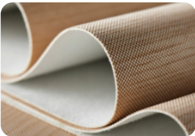
Le matériau composite flexible NUO FlexHolz associe un placage de bois véritable à un support textile en chanvre ou en cellulose et à une couche adhésive biosourcée à base de lignine. Il peut être cintré tout en conservant une bonne stabilité dimensionnelle. Photo : DITF (Deutsche Institute für Textil- und Faserforschung Denkendorf)
