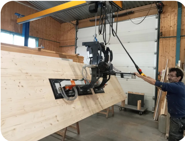
À la Menuiserie Antoine Aresti, un pont roulant avec palonnier permet de manutentionner les panneaux sans mobiliser un second salarié. Photo : Assurance Maladie
