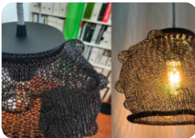
Abat-jour autoportant réalisé en FormLig, un matériau obtenu à partir de fibres de cellulose revêtues de lignine puis mises en forme par tricotage et thermoformage. Photo : DITF
