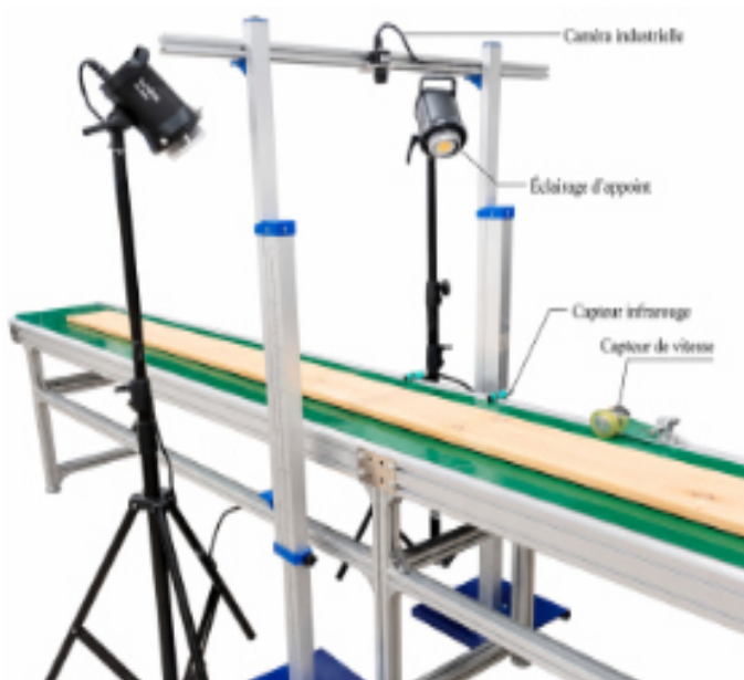
Schéma de principe du système d'acquisition d'images développé en interne. Illustration : Qin et al., Forests, 2025. Licence CC BY 4.0. Illustration traduite en français et fond modifié
