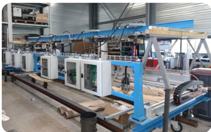
Marquage des planches en fonction du schéma de découpe décidé par l'algorithme - Photo : Scierie Tarteret
