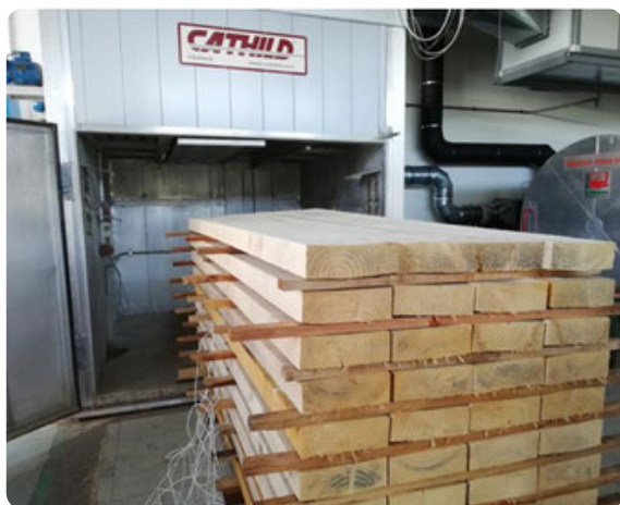
Lot de bois avant chargement pour un essai de séchage Solarwood au FCBA de Bordeaux Photo : FCBA
