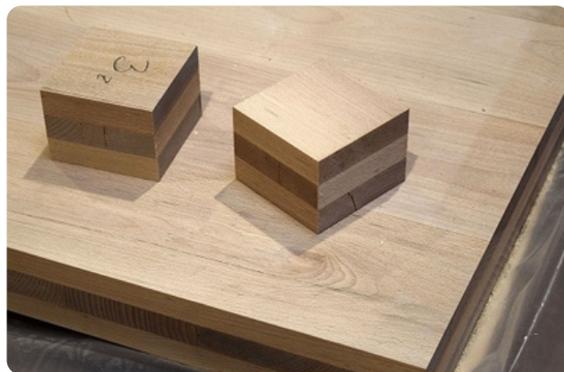
Panneau CLT en hêtre modifié - Photo : HS Rottenburg / Lukas Müller
