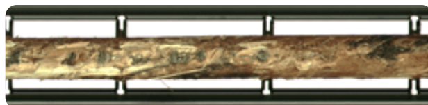
Bille mal écorcée (sèche) - Crédit photo : FPInnovations
