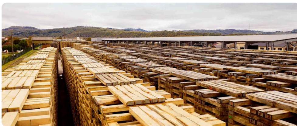
Traverses traitées à l'huile cuivrée à Bretenoux-Biars - Photo : SNCF
