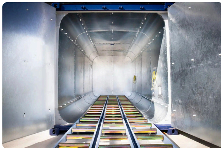
Séchoir sous atmosphère CO 2 installé. Photo : Ways
