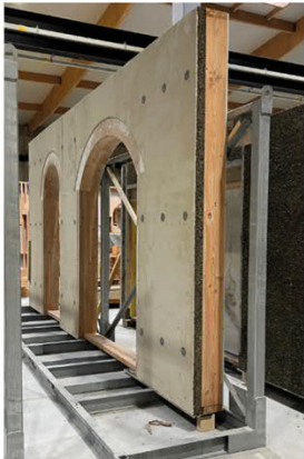
Mur Wall'up fabriqué et sec, dans l'atelier de Wall'up sur chaise de transport, juste avant le départ sur chantier • 2023 • ©Wall'up
