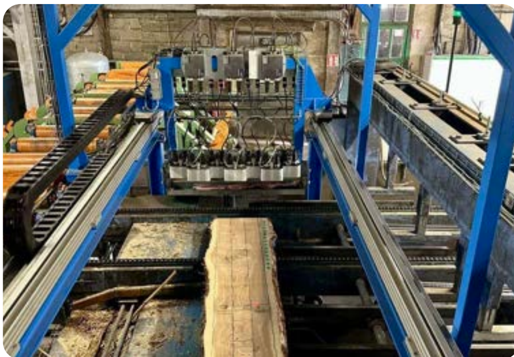
Scierie Tarteret : identification des singularités en amont du sciage (Photo : Mator Barine)
