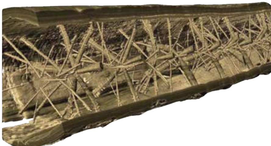
Scanner tomographique d'une grume - Illustration : Microtec
